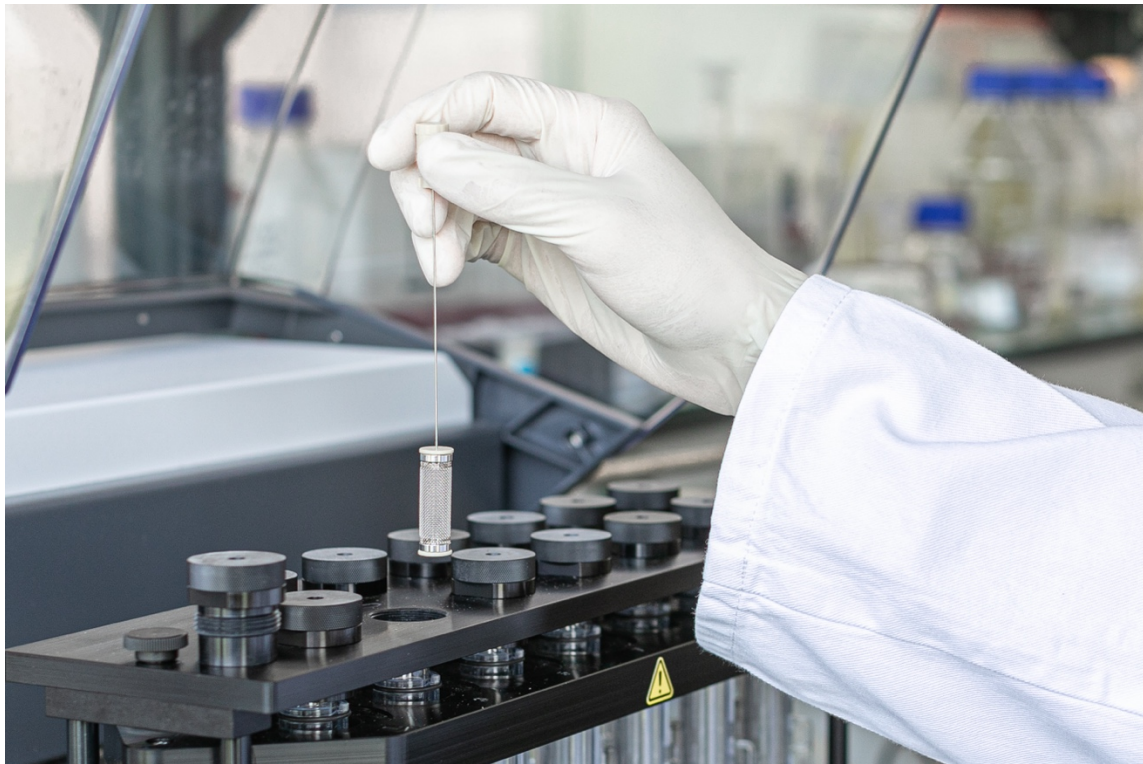
Abbildung 2: Degradations-Apparatur zur Inkubation degradierbarer Materialien in simulierten Körperflüssigkeiten für Echtzeit- oder beschleunigte Abbauprüfung (©Patrick Hipp)
